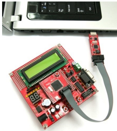
<그림 2-1> LK ATmega128-A2트레이닝 보드의 USB AVRISP를 연결 한 사진
